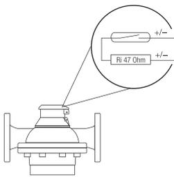
Cet émetteur est incorporé au totalisateur à rouleaux et se prête particulièrement à la totalisation à distance. Pour d'autres applications, il sera préférable d'utiliser l'émetteur inductif IN.
