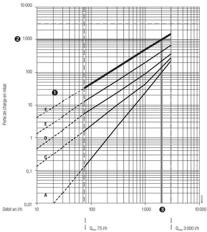
Liquide huile minérale, viscosité 450 mPa.s, installation d'un VZO 25 côté pression
